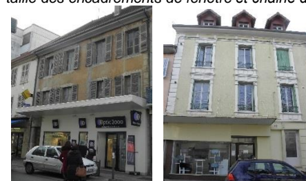
Dénaturation : Façade commerciale en rupture avec la composition de l'immeuble : auvent sur tout ou partie de la façade, plaquage, dissymétrie des ouvertures de la vitrine par rapport à celles de la façade ...
