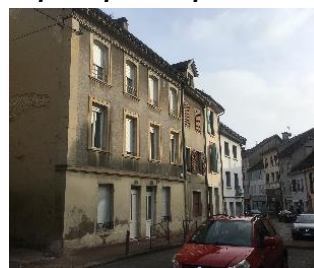
Immeuble simple fin XIXème, soubassement différencié et modénature en ciment moulé, passée de toit avec lambrequin rue Girerd-26_p119 -c2
