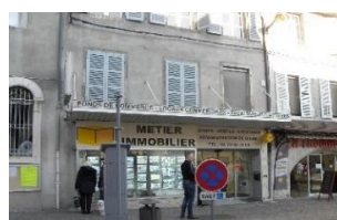
Dénaturation : déséquilibre de la composition des façades par rajouts d'éléments parasites en rez-de-chaussée, disparition des ouvertures d'origine, Recouvrement des belles dalles en pierre
