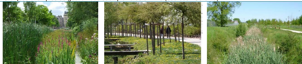
Noues, fossé humide, bassin biotope collectent en surface les eaux pluviales avant infiltration dans le sol, voire Collecte et traitement des eaux pluviales par un dispositif de filtration végétalisé (noues, bassin, jardins filtrants).
